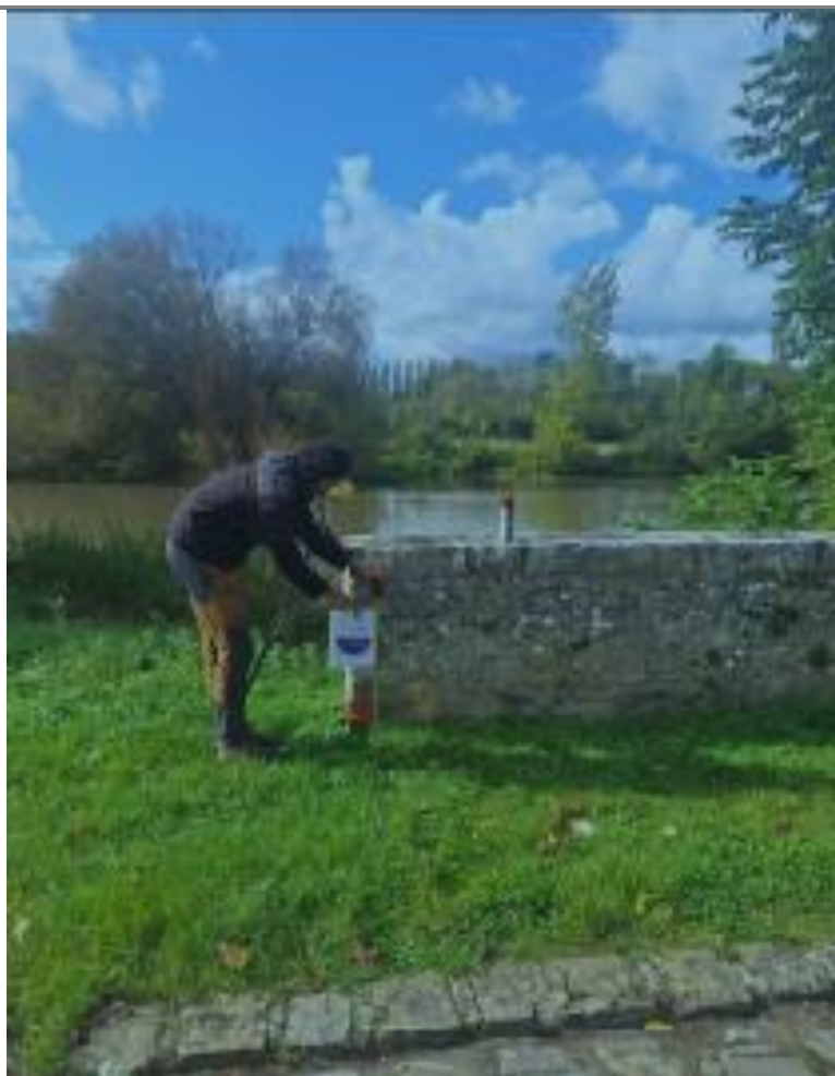
ARTELIA et le géomètre lors du géoréférencement des repères de crue (Source : CC4V)
